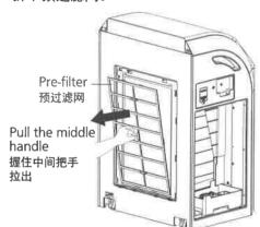
(3)Remove the HEPA composite filter. 拆下HEPA多功能过滤网。
